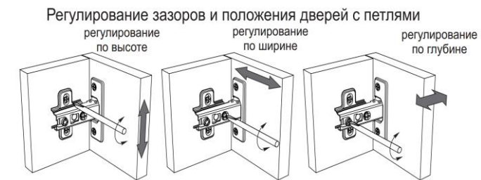
Рисунок 6 - Схема регулировки петель
