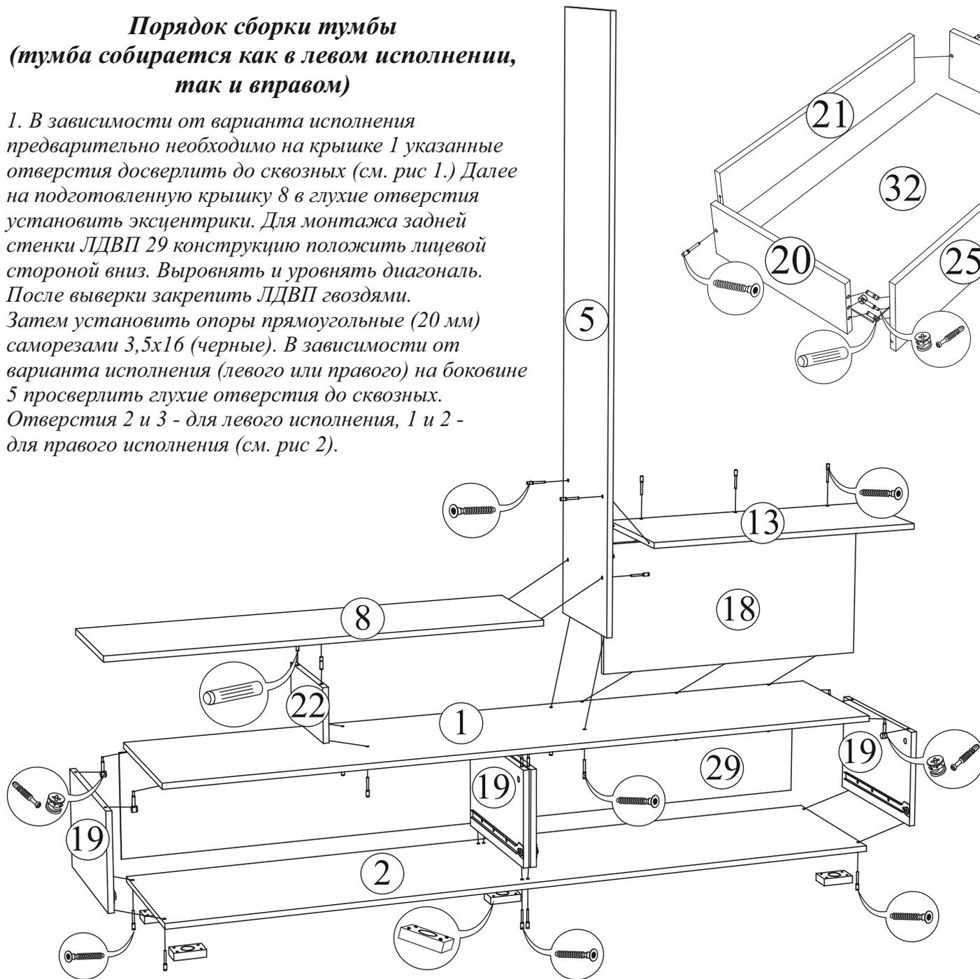
Монтаж эксцентриковой стяжки
