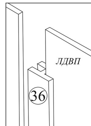
Для правильного открывания дверей и ящиков, необходимо выровнять диагонали каркаса (Рис. 1) и только потом прибить ЛДВП не нарушая диагонали.
